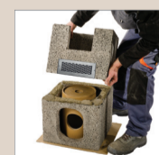
5. Osadzić pustak z wyciętym otworem na drzwi czyszczki (16x31 cm) oraz na kratkę przewietrzającą
